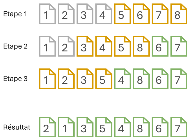
FIGURE 2 – Exemple de stratégie de fenêtre glissante : La fenêtre est indiquée en orange et les passages réordonnés en vert . Pour une fenêtre de taille 4 et un pas de 2, le réordonnement d’une liste de 8 passages nécessite trois itérations.
